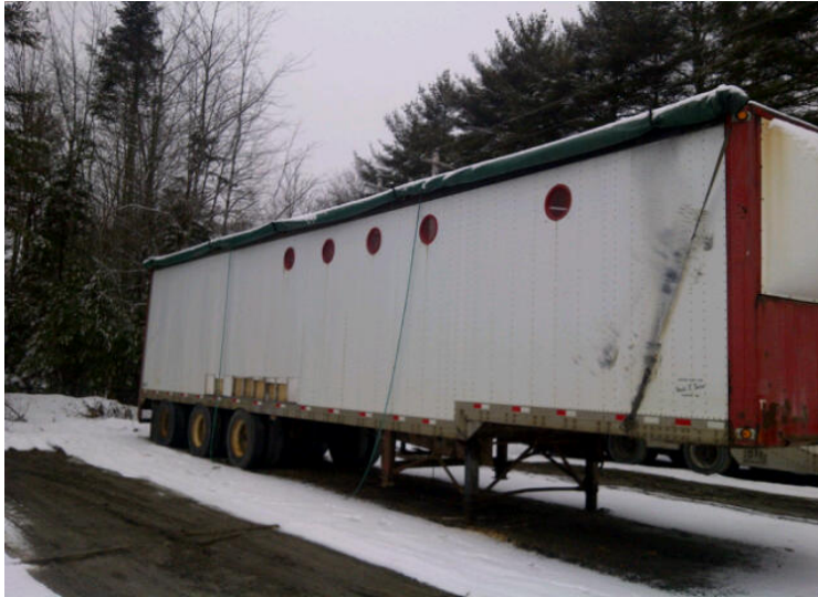
Voici une photo de la bâche déjà enroulée dans son logement
